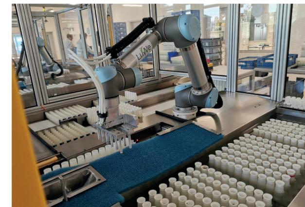
Roboter zur Probenvorbereitung
